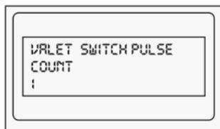
Mit Drücken der Taste „SELECT“ legen Sie fest wie oft der Service-Taster gedrückt werden muss, um das System ohne Fernbedienung zu entschärfen.
