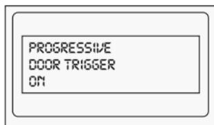
Das Alarmsystem meldet in der Werkseinstellung („ON“) einen Alarm über den Türkontakt-eingang mit 10 kurzen Sirenenchirptönen bevor ein Vollalarm ausgelöst wird. Mit der Einstellung „OFF“ ertönt sofort ein Vollalarm ohne Vorwarnung.
