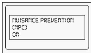
Der Antifehlalarm stoppt endgültig einen wiederkehrenden Fehlalarm einer defekten Alarmzone. Sollte z.B. eine Alarmzone innerhalb einer Stunde 3 - mal einen Alarm auslösen so wird diese Alarmzone für eine Stunde abgeschaltet.
