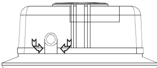
Einstellungen erfolgen über den Drehknopf, wie oben angezeigt ist. Da der Schocksensor nicht gut funktioniert, wenn er fest an Metall angeschraubt ist, empfehlen wir das Befestigen des Steuermoduls mittels Kabelbinder. Die komplette Auslösung des integrierten Schocksensors zeigt die Zone 2 an.
