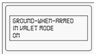
Mit eingeschaltetem Feature („ON“) liegt auch im Service-Modus nach Verriegelung der Fahrzeurtüren am orangen Kabel („Masse wenn scharf“) eine Masse an. Bei ausgeschaltetem Feature („OFF“) liegt keine Masse auf dem orangen Kabel.
