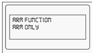
Mit Drücken der Taste „SELECT“ wechseln Sie zwischen den Einstellungen: „Multilevel Arming“ kann die Sensoren ausschalten, „Panic“ kann den Panikalarm auslösen, „Aux channel“ kann die Optionale Funktion steuern und mit „Arm Only“ wird ausschließlich geschärft.
