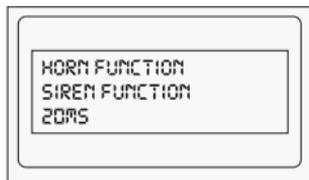
Mit Drücken der Taste „SELECT“ gelangen Sie in die Unterauswahl „20MS / 30MS / 40MS / 50MS (Sirene) Full Alarm Only (Hupe)“.
