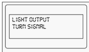
Mit Drücken der Taste „SELECT“ können Sie einstellen, ob die Blinker oder das Standlicht aufleuchtet. Sie können wechseln zwischen Parking Lights und Turn Signal. (Nicht über CAN).
