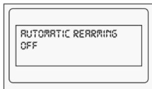
Mit Drücken der Taste „SELECT“ können Sie eine automatische Schärfung des Systems bestimmen, wenn nach dem Entschärfen keine Tür geöffnet wurde.
