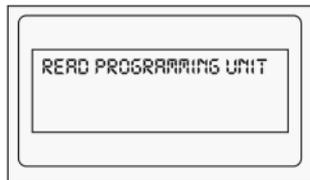
Durch Drücken der Taste „READ“ werden die aktuellen Einstellungen der Alarmzentrale ausgelesen. Es erscheint die links dargestellte Displayanzeige.
