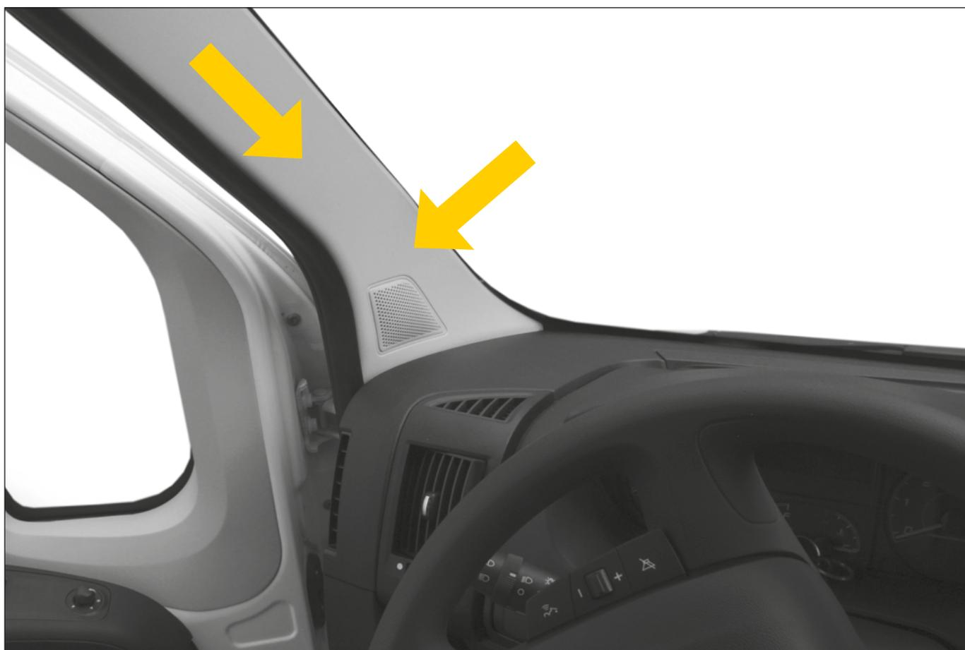
Bei vielen Fahrzeugen kann der Hochtöner hinter der A-Säule angebracht werden. Ersetzen Sie dann den Original-Hochtöner mit dem ESX-Hochtöner. Wir empfehlen, den Hochtöner mit Heißkleber zu sichern.
