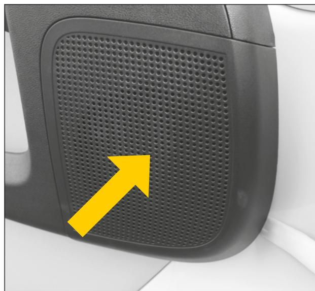
Um den Hochtöner zu installieren, entfernen Sie zunächst die Abdeckung der A-Säule durch vorsichtiges Abziehen. Wenn Ihr Fahrzeug mit einem Frontfenstervorhang ausgestattet ist, müssen Sie zuvor die waagerechte Schienenschiene des Vorhangs lösen.
