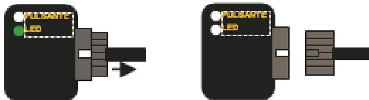
2. Drücken und halten Sie dann den Reset Schalter des Interface fest und verbinden den Stecker des Kabelsatzes mit dem Interface.
