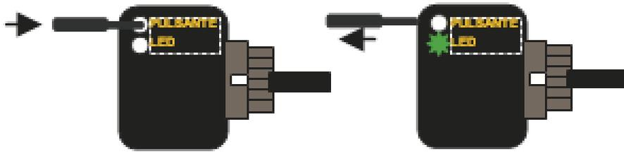
4. Die grüne LED fängt nun an zu blinken und zeigt damit das eingestellte Ausgangssignal laut der Tabelle an. Um das Ausgangssignal zu ändern muss der Reset Schalter kurz gedrückt werden. Bei jedem Druck wird der nächste Schritt in der Tabelle gewählt und durch blinken der grünen LED bestätigt.
