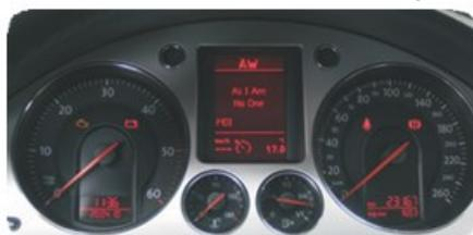
Es gibt zwei Hauptbildschirme, die auf dem zentralen Display (Audio- und Telefon-Display) angezeigt werden können. Das Auswählen dieser Bildschirme ist mit der "Menü" Taste am Lenkrad möglich (falls vorhanden).
