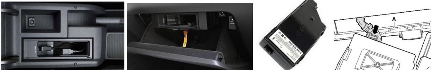
Ist das MDI wie oben links in der Mittelkonsole verbaut, kann es mit den Radioentriegelungs-schlüsseln gelöst und dann herausgezogen werden. Der Stecker sitzt unter dem Interface.
