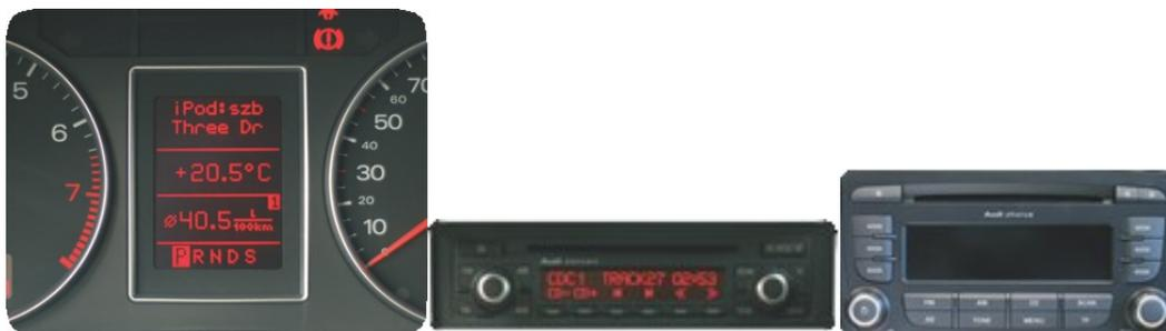
Das Menü des Gateway Pro BT wird auf dem zentralen Display (Cluster) im Armaturenbrett (zwischen den beiden Hauptinstrumenten) angezeigt.
