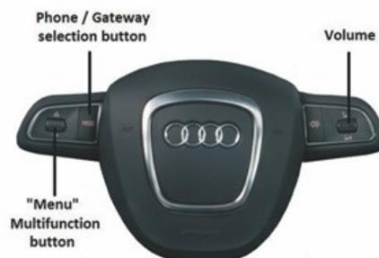
Das Menü kann mit den Lenkradtasten gesteuert werden. Sie können das Hauptmenü des Gateway Pro BT auswählen, indem sie kurz die "Menu" Multifunktionstaste drücken. Verwenden sie die gleiche Taste für Browsing, rollen sie nach unten ( $\Delta$ ) oder nach oben ( $\blacktriangledown$ ), für den Zugriff auf unterschiedliche Menüoptionen. Drücken sie kurz ein Untermenü oder lange die Eingabetaste, um zur vorherigen Ebene zurückzukehren.
