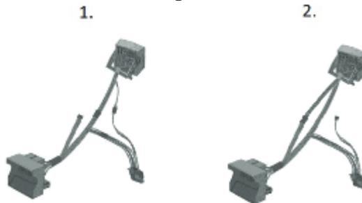
**Wenn sie nur die Freisprecheinrichtung und A2DP** verwenden möchten, weil ab Werk bereits ein original MDI-Interface verbaut ist und nicht die Mediafunktionen des Interfaces (USB, AUX), dann stellen sie DIP 1-5 auf "OFF" und DIP 6 auf "ON".
