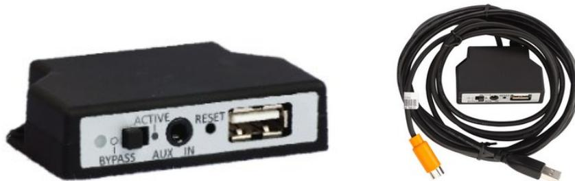
Bitte platzieren sie den Connector Port in eine Position, in welcher der Benutzer auf die Eingänge zugreifen kann und lassen Sie genügend Platz für die Befestigung der USB-Speichergeräte.
