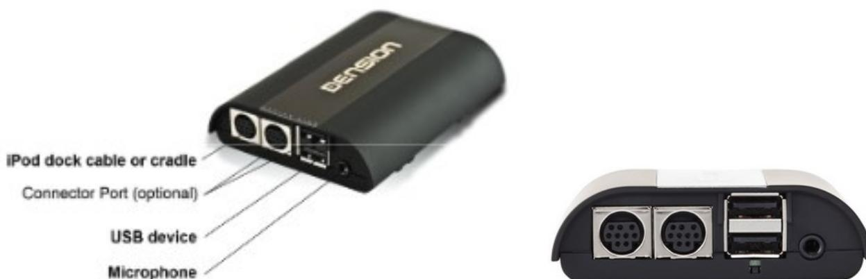
Verbinden sie den 18 poliger Stecker mit dem Gateway Pro Moduls auf der Geräterückseite. Schließen Sie den **runden iPod-Anschluss (optional, Art.Nr. D\_IPDC1GW)** und Anschluss-Port (optional, Art. Nr. D\_Ext1CP2) an das Modul und suchen sie einen geeigneten Ort. Sie können an dem unteren USB-Eingang direkt USB-Sticks oder ein iPhone 5/6/6Plus anschließen. Der obere USB-Anschluss ist für den Anschluss des „Connector Ports“ vorgesehen.
